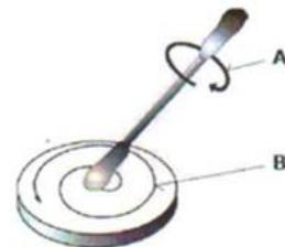
A 棉签旋转方向 B 圆弧运动清洁镜片
