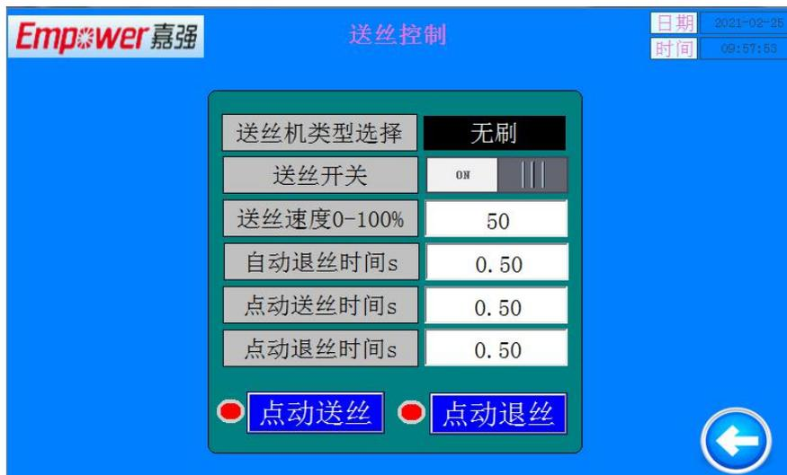
送丝机类型选择：无刷直流电机与步进电机两种。
