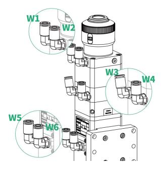
冷却水进出的方向可以参照图示进行连接。
