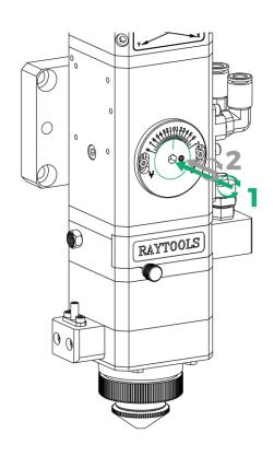
注: 逆时针转动转盘为负焦点方向, 顺时针转动转盘为正焦点方向, 焦点范围-8mm~+7mm;
