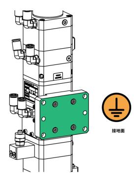
接地不当可能会因零件运动 (激光头的抖动或振动) 导致传感机构故障和设备损坏。
