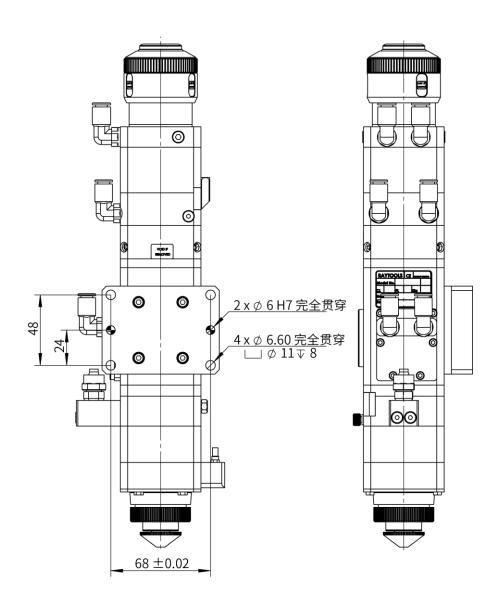
(i) 建议按照要求,将激光头垂直于加工面安装,并保证螺钉紧固,避免激光头振动。
