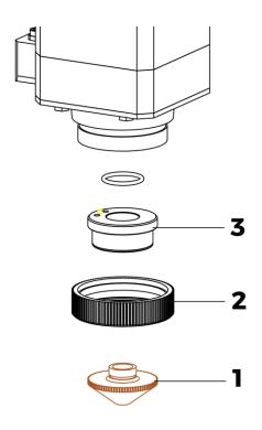
清洁陶瓷体/环的脏污,必要时更换;喷嘴因激光束受损或发生碰撞后需要更换喷嘴。
