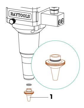
清洁陶瓷体/环的脏污,必要时更换;喷嘴因激光束受损或发生碰撞后需要更换喷嘴。
