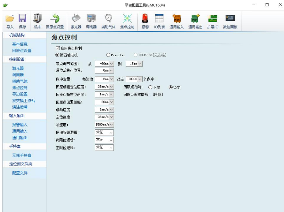
图 3.6 BM114 100/150 光学配比焦点参数设置值
