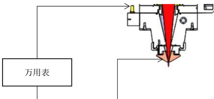
测量喷嘴/插座顶针和切割头外壳以及陶瓷环锁紧环，判断 TRA 组件是否内部短路
