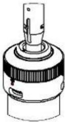
光学器件必须保持洁净，在使用之前必须清除所有灰尘。如果激光头为光纤垂直插入，那么就必须将激光头旋转 90 度到水平放置，再插入光纤以阻止灰尘从接口进入掉落在镜片表面。插好光纤后再固定激光头。
