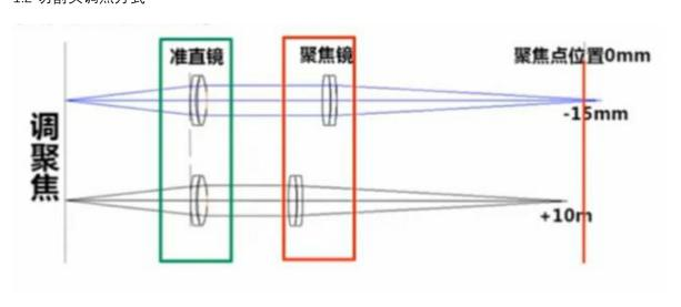
电机移动的距离和焦点变化的距离是线性的,电机移动距离:焦点移动距离=1:1。
